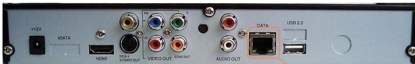
Подключите LAN-кабель к разъему DATA на ТВ-приставке и к Вашему ADSL Router или ADSL Modem.
