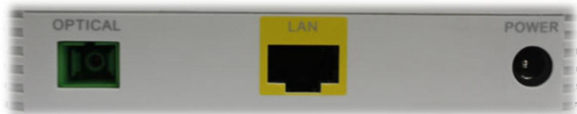
Рис. 1 Задняя панель
