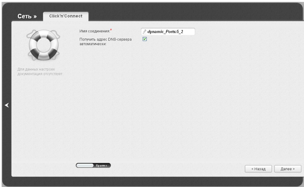
Рисунок 35. Настройка WAN-соединения типа *Динамический IP*.
