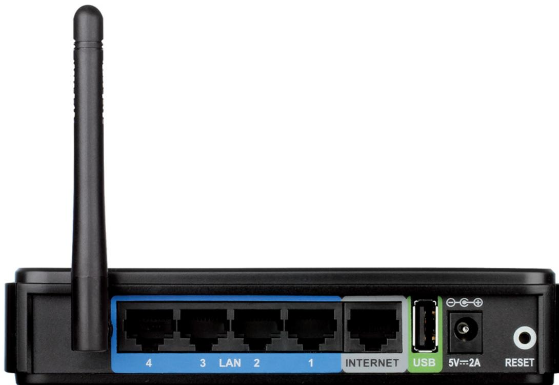
Рисунок 2. Вид задней панели DIR-320NRU.
